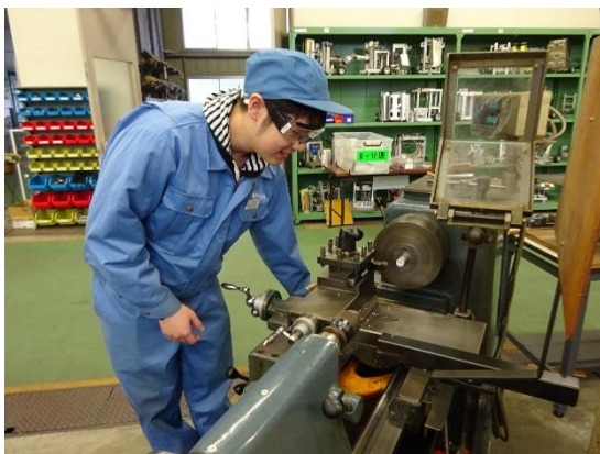
軸加工(汎用旋盤)
