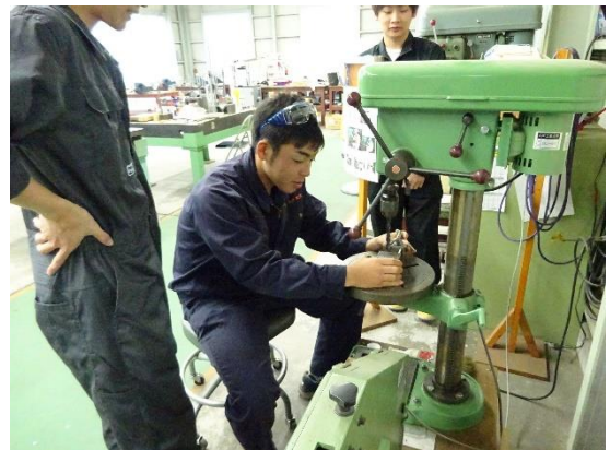
穴あけ加工(ボール盤)
